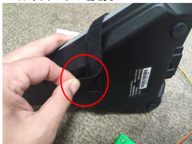
① インスタコード裏面に回ったマジックテープの端を持つ
