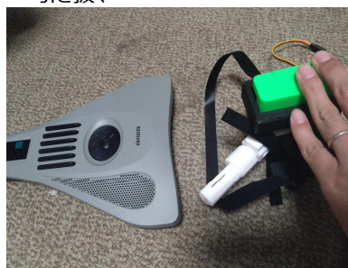
③ 固定台をインスタコードの底面方向に引き抜く
